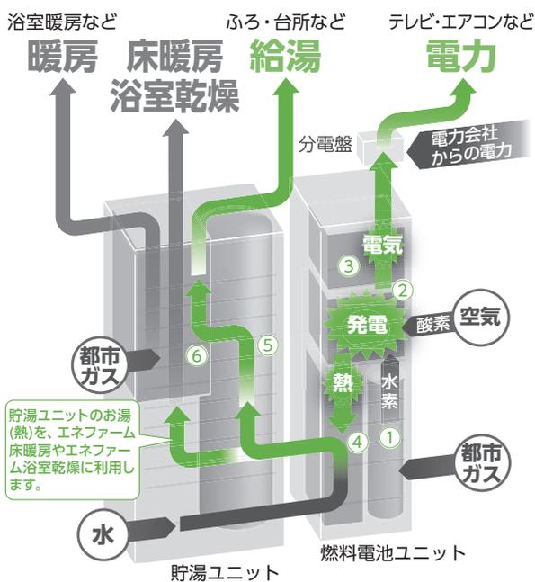
エネファームは、都市ガスから作った水素を、空気中の酸素と化学反応させ、「電気エネルギー」と「熱エネルギー」を創り出しています。
