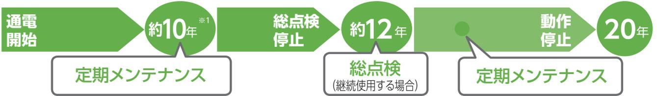
■ 発電電力量約28,800kWh<sup>※2</sup> (約10年<sup>※1</sup>)で1回目の定期メンテナンスが必要です。
