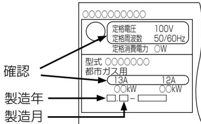
他のガス種・電源を使用すると機器が正常に作動しなくなり、異常燃焼し、一酸化炭素中毒などの原因となります。
