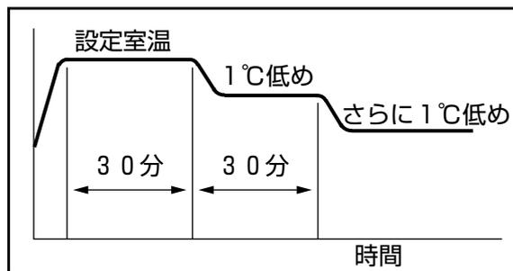
セーブ運転中は設定室温に達すると、30分毎に設定室温を1℃ずつ2回にわたって、自動的に下げて運転します。設定室温表示は変化しません。
