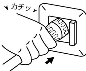
ガスコードのガス栓用ソケット側をガスコンセントに”カチッ”と音がするまで差し込みます。
