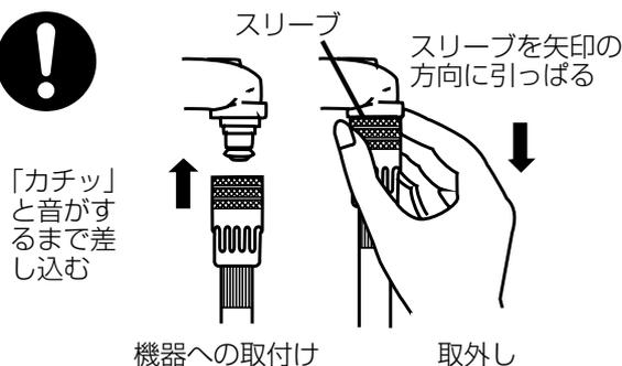
確実に接続されていないとガス漏れが生じ、爆発や火災の原因となります。
