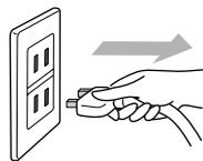
コードを引っばると、コードが破損し、感電・ショート・火災の原因となります。
