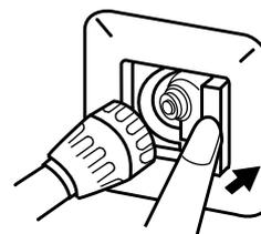
右側にあるフタを押すとソケットが外れ、ガス栓が閉じます。
