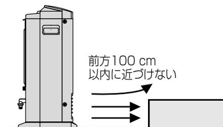
温風が当たる部分の変色やひびわれするおそれがあります。必ず機器は水平な所（確実に設置できる所）に設置して使用してください。
