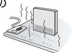
機器の重みで、電気カーペット・温水マットが故障する場合があります。また、電気カーペットや温水マットの熱で機器が正しい制御をしないことがあります。
