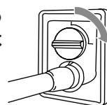
4. ガスコードを外し、ガスコードと機器のガス接続口にキャップをする
