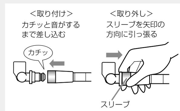
確実に接続されていないとガス漏れが生じ、爆発や火災の原因になります。
