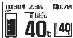
浴室リモコン表示部
