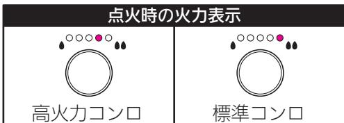
※高火力コンロは安全のため、火力表示4で点火します。
