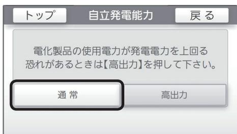
※ 通常モードに戻し忘れた場合は消費電力低下から約5分後に機器保護のため自動的に通常モードに戻ります。
