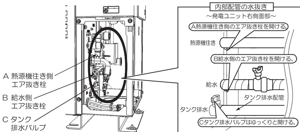
⑩ タンク排水配管より湯（水）が出なくなったら、B給水側、A熱源機往き側のエア抜き栓を閉め、Cタンク排水バルブを閉じます。
