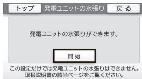
⑥11ページの「フロントR小パネルの取り外し方法」を参照し、発電ユニットのフロントR小パネルを外した後、発電ユニットの給水バルブ・熱源機メンテ用バルブを開けてください。（60ページ参照）
