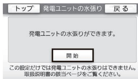
⑥11ページの「フロントR小パネルの取り外し方法」を参照し、発電ユニットのフロントR小パネルを外した後、発電ユニットの給水バルブ・熱源機メンテ用バルブを開けてください。（19ページ参照）
