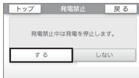
※ 約10～12時間後に発電停止表示は消灯し、リモコントップ画面の左上に[発電禁止]と表示されます。
