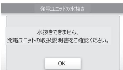
水抜きは、発電ユニットが停止状態のみ受け付けます。発電ユニットが完全に停止後、再度操作してください。
