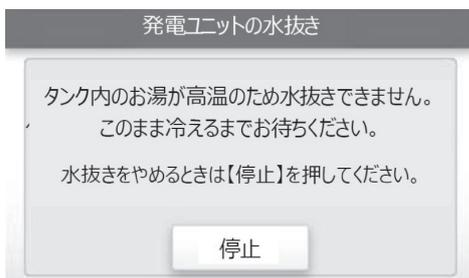
※ タンク内温度が低い場合でも約10分間は冷却します。
