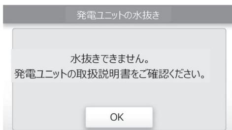
水抜きは、発電ユニットが停止状態のみ受け付けます。
