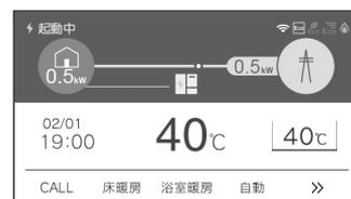
※ 発電ユニットが停止動作完了後でなかった場合は、表示は [停止中] と表示します。この場合は停止動作完了後に [起動中] に切り替わります。
