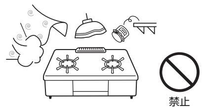
**周囲に可燃物**（木製などの可燃性の壁、ステンレス板や薄いタイルなどの不燃材を可燃性の壁に直接貼り付けた壁、たななど）**のある場合**
