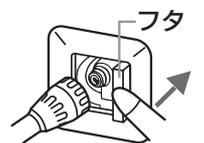
ガスコンセントは、ガスコードなどを取り付けると自動的に開栓し、取り外すと自動的に閉栓します。
