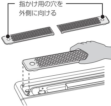
指かけ用の穴を外側にし、トッププレート後方のくぼみにセットしてください。
