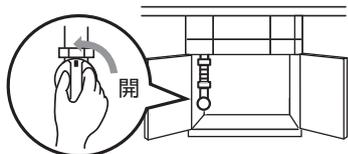
全ての操作ボタンが消火位置であることを確認し、ガス栓を全開にする
