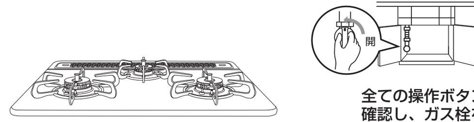
全ての操作ボタンが消火位置であることを確認し、ガス栓を全開にする
