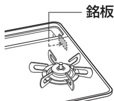
銘板は機器内部の右側面に貼り付けてあります。グリル排気口カバーを取り外してご確認ください。
