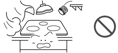
**周囲に可燃物**（木製などの可燃性の壁、ステンレス板や薄いタイルなどの不燃材を可燃性の壁に直接貼り付けた壁、たななど）**のある場合**
