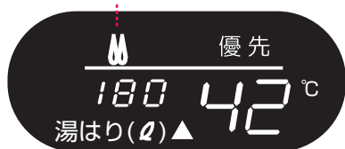
燃焼確認ランプ点灯
