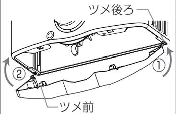
※ツメ後ろ2か所を取り付け穴に差し込んだ後、ツメ前2か所を取り付け孔にはめ込んでください。
