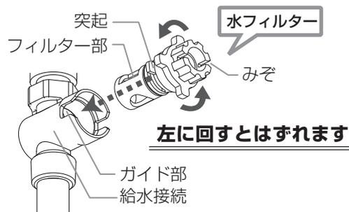
※水フィルターには上下の方向があります。フィルター部を上側にし、突起を給水接続のガイドに合わせて取り付けてください。
