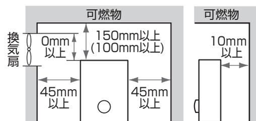
※上記寸法は防火上の離隔距離です。メンテナンス上、機器前方は600mm以上、側方は200mm以上確保してください。※機器上方が換気扇などの上端より下方となるように設置してください。
