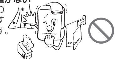
火災予防条例により、機器周囲は可燃物から上方は150mm以上、側方は45mm以上、後方は10mm以上離して設置する
