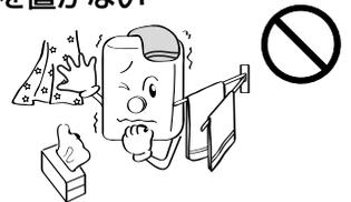
火災予防条例により、機器周囲は可燃物から上方は150mm以上、側方は45mm以上、後方は10mm以上離して設置する
