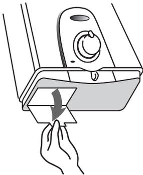
① 機器底面にある電池ケースのフタを開けます。
