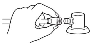
コンセント継手を差し込むとガス栓が開きます。
