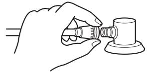
コンセント継手はずれるとガス栓が閉まります。
