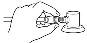
コンセント継手がはずれるとガス栓が閉まります。
