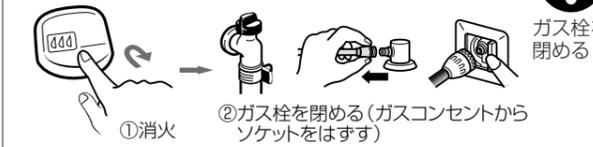
①消火 ②ガス栓を閉める(ガスコンセントからソケットをはずす)
