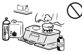
■地震、火災、または使用中に異常な燃焼、臭気、異常音を感じた場合、使用中で消火した場合はただちに使用を中止し、ガス栓を閉じる(つまみのないガスコンセントの場合は、ガスコンセントからソケットをはずす)
