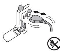
電気器具（換気扇その他）のスイッチの「入・切」をしない。
