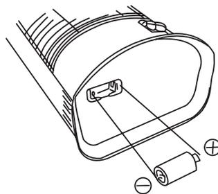
単2形 1.5V の乾電池を使用し確実にセットしてください。逆向きにセットすると、乾電池の発熱・破裂・液漏れなどの原因となります。
