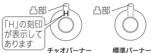
凸部を後にしてバーナー本体前側の凹部にバーナーキャップのピンを入れて正しく取り付けてください。
