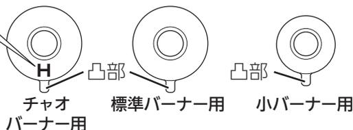
1. バーナーキャップの凸部を前にして、バーナー本体後側の凹部にバーナーキャップのピンを入れて、正しく取り付ける。
