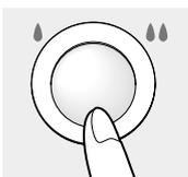
操作ボタンを奥に当たるまで押して戻してください。点火確認ランプと操作部のランプが消灯します。
