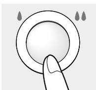
調理終了後は操作ボタンを押して戻してください。点火確認ランプと操作部が消灯します。
