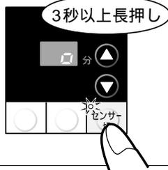
センサー「切」キーを3秒以上長押しします。表示部が「」「」「」と表示されます。「」が表示されたとき、「ピッ」とお知らせすると同時にセンサー「切」ランプが点灯し、鍋なし検知機能を解除します。
