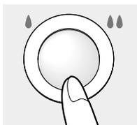
調理終了後は操作ボタンを奥に当たるまで押して戻してください。点火確認ランプと操作部のランプが消灯します。
