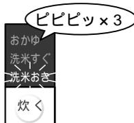
炊き上がりますと、自動で消火し、ブザーで「ビビピッ×3」とお知らせし、点火確認ランプが点滅します。同時に表示部に「10分」と表示され、むらし時間のカウントダウンが始まります。
