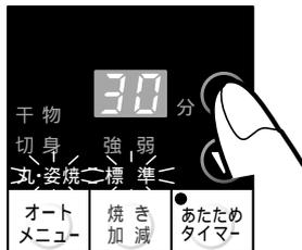
焼き上げが完了するとブザーで「ピピピッ×3」とお知らせし、同時に表示部に「30」と表示され、カウントダウンが始まります。
