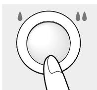
操作ボタンを奥に当たるまで押して戻してください。点火確認ランプと操作部のランプが消灯します。
