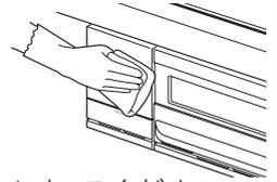
※機器内部に洗剤が入らないようにしてください。電子部品に付着して作動不良や腐食により、故障の原因になります。
