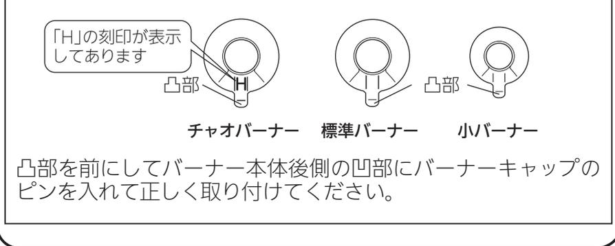
凸部を前にしてバーナー本体後側の凹部にバーナーキャップのピンを入れて正しく取り付けてください。
