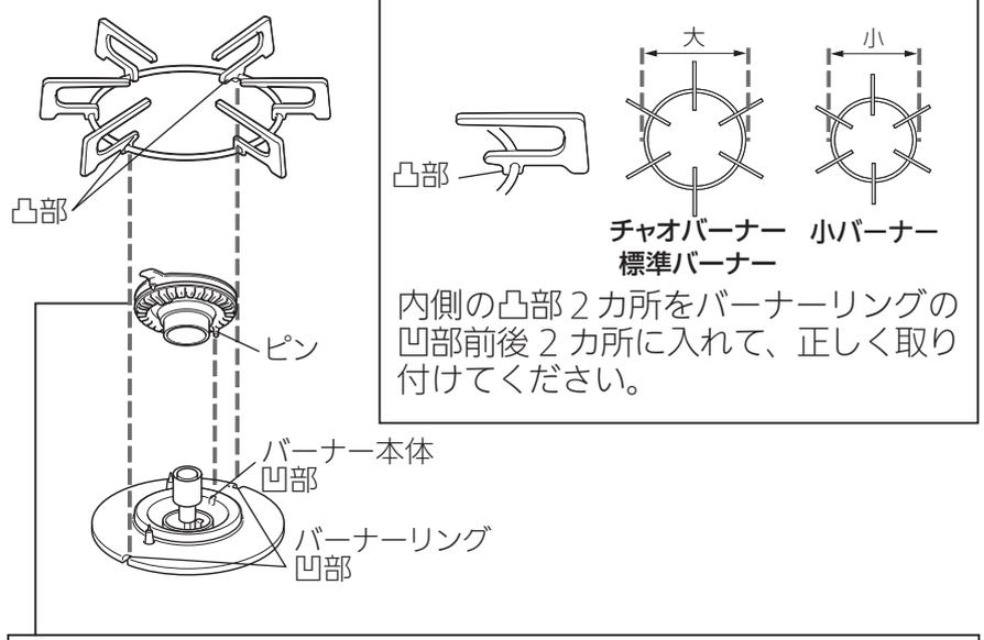
内側の凸部2カ所をバーナーリングの凹部前後2カ所に入れて、正しく取り付けてください。
