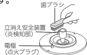
※電極（点火プラグ）の先端はとがっていますので、けがなどに注意してください。
