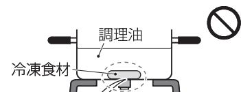
冷凍食材を鍋の底面中央(温度センサーの接触位置)に密着させない
