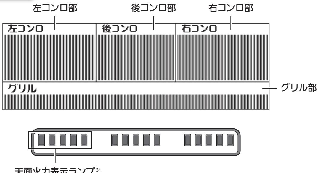
※天面火力表示ランプは、コンロの火力表示ランプと同様に点灯、点滅します。
