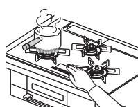
1カ所のみコンロを使っている場合でも、使っていないコンロ側のトッププレートも熱伝導で熱くなる場合があります。触らないよう注意してください。
