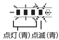
●点火すると、左／右コンロは、弱火側から3個点灯し4番目が点滅します。（中火点火機能）
