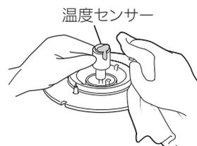
※強い力を加えると、温度センサーが傾いて、鍋底に密着しないことがあります。また、温度センサーを無理に回転させないでください。故障の原因になります。
