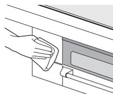
※機器内部に洗剤が入らないようにしてください。電子部品などに付着して、作動不良や腐食などの機器故障の原因になります。
