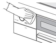
※ツマミリングがはずれたときはツマミリングのツメ（3カ所）を溝に合わせて押し込んでください。
