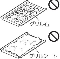
異常燃焼による一酸化炭素中毒や、機器損傷の原因になります。
