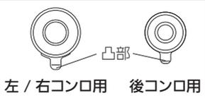
1. バーナーキャップの凸部を前にして、バーナー本体後側の凹部にバーナーキャップのピンを入れて、正しく取り付ける。
