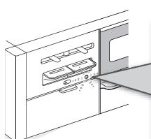
電池交換サインが点滅したら、コンロやグリルが使用できなくなります。早めに新しい単 1 形アルカリ乾電池 (1.5V) 2 個と交換してください。
