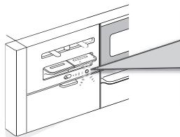
電池交換サインが点滅したら、コンロやグリルが使用できなくなります。早めに新しい単1形アルカリ乾電池(1.5V)2個と交換してください。
