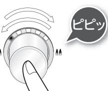
火力表示ランプは「弱火」から「強火」、「強火」から「弱火」の点灯を繰り返します。
