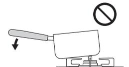
■陶器製鍋を使用する場合は、長時間の使用は避け、中火以下の火力で使用する
