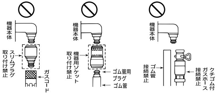
ガス栓がガスコンセント接続の場合、ソケットを差し込むと、自動的に開栓し、取り外すと自動的に閉栓します。
