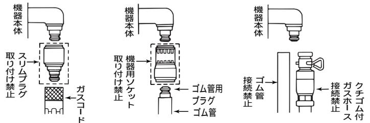
ガスコードの上に物をのせたり、踏まれるまたは挟まれる状況で使用しないでください。またガスコードを、継ぎ足したり天井などを通さないでください。ガス漏れが生じ、火災の原因になります。
