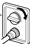
お部屋のガス栓（例）
