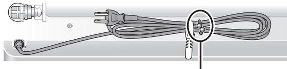
コードホルダーを広げ、たばねた電源コードをはさみ、先端をひねって固定してください。
