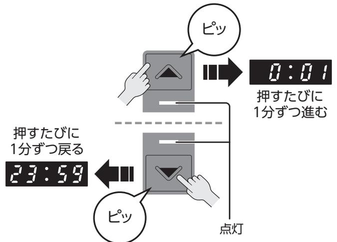
初めてお使いのときは、室温 / スポット / 時刻 / 時間スイッチを1回押すと表示部に「0:00」が点滅表示されます。
