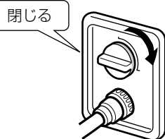
お部屋のガス栓（例）
