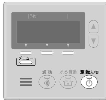
ふる配管内の残り湯を新しいお湯で洗い流す機能が「ふる配管クリーン」です。以下の操作で、手動でふる配管クリーンができます。
