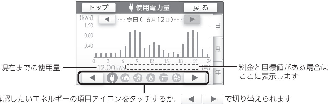
太陽光発電システムおよび電力測定ユニットがある場合の表示例
