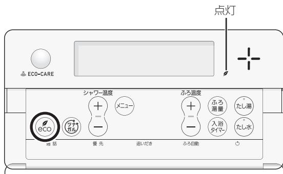
■ 下記画面を表示している間(約10秒間)は、シャワー温度スイッチでシャワーのひかえめ給湯量が変更できます
