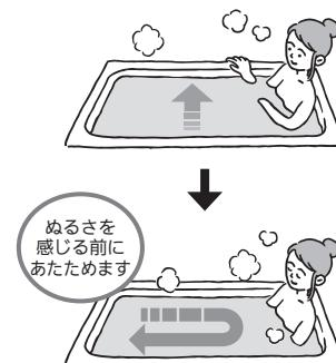
入浴すると水位が上がり、水位センサーが検知します。
