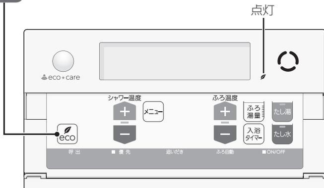
下記画面を表示している間(約10秒間)は、シャワー温度スイッチでシャワーのひかえめ給湯量を変更できます
