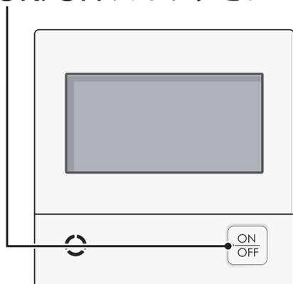
優先表示が点灯すると、台所リモコンで記憶していた給湯温度を表示し、お湯の温度が調節できます
