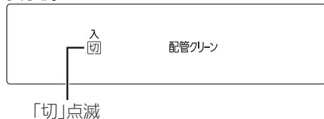
**3** シャワー温度スイッチの【+】を押して「入」を点滅させる
