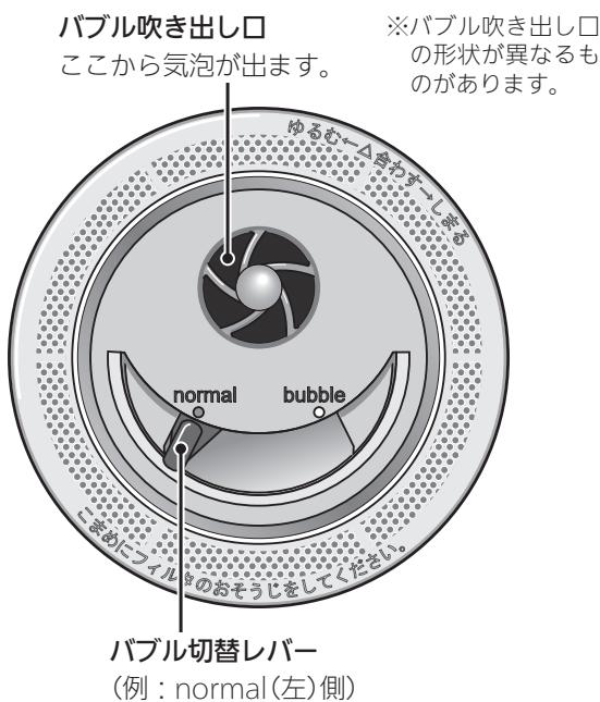
状況にあわせてバブル切替レバーを操作してください
