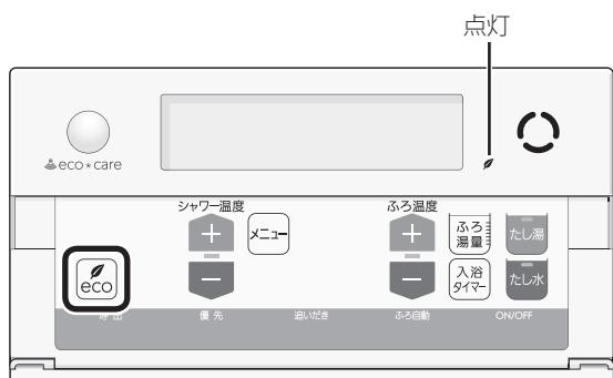
3. シャワー温度スイッチで、点滅している数字を変更する
