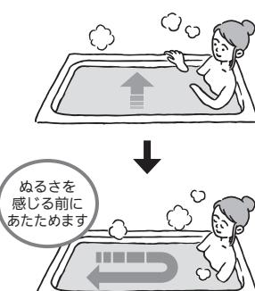
入浴すると水位が上がり、水位センサーが検知します。
