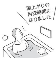
3. 浴槽から出て(水位センサーが検知)、浴室から退室する(エコ・ケアセンサーが検知)と、入浴タイマー 終了
