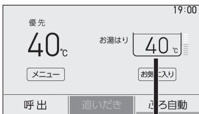
現在のふろ温度(目安) 39・40°C 沸かし中 設定したふろ温度
