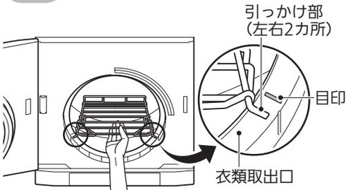
小物乾燥棚が水平になるように、目印より下方の左右2カ所に位置を合わせてください。
