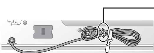
コードホルダーを広げ、たばねた電源コードをはさみ、先端をひねって固定してください。
