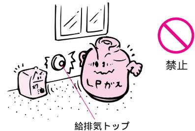
給排気トップ周辺の障害物(壁面等)とは、常に右図以上の距離を確保する。
