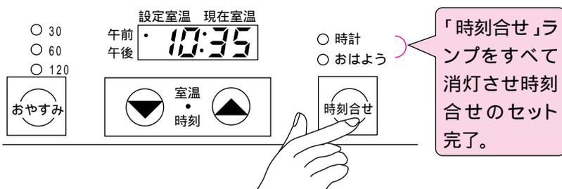
「時刻合せ」スイッチを押した時点で午前10時35分0秒からスタートし、表示部のコロンが点滅し時計が動きます。
