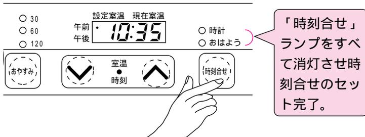
「時刻合せ」スイッチを押した時点で午前10時35分0秒からスタートし、表示部のコロンが点滅し時計が動きます。
