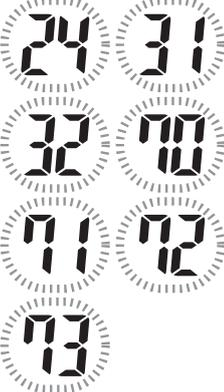
が点滅 | <ul style="list-style-type: none"> <li>センサー・スイッチなどが異常です。</li> </ul>                                     | <p>取消スイッチを押して停止してから、再操作してください。</p> <p style="text-align: right;">※</p>                                                                                                                                                       | —        |
