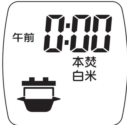
※1時間以上電源プラグを差し込んでおくと、停電が起きたときや、電源プラグを抜いたときでも、約12時間は時計機能がはたらきます。電源プラグを抜くと表示は消えますが、電源プラグを差し込むと現在時刻が表示されます。
